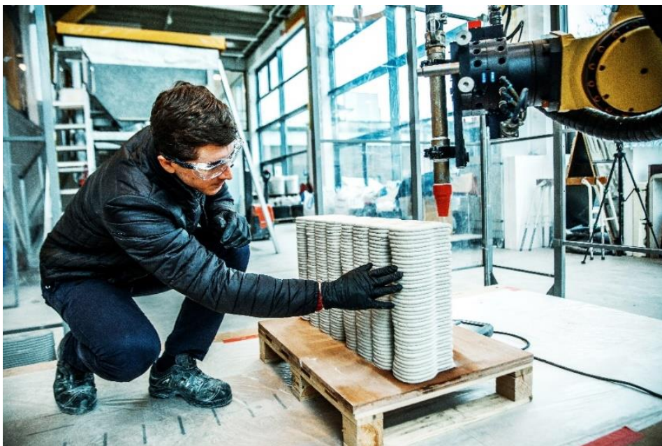
Teknologisk Institut har bl.a. udviklingsfaciliteter, hvor der arbejdes med 3D print i beton.
