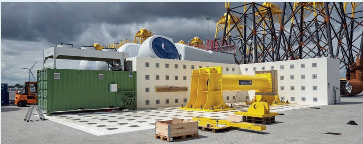
FORCE Technology og LORC står bag Lindoe Component and Structure Testing A/S. Her er der bl.a. en mekanisk testbænk til test af meget store komponenter og strukturaldele til glæde for især off-shore industrien. Foto: FORCE Technology.
