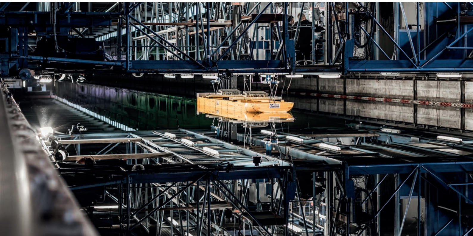
Inden et skib kan komme på sin jomfrurejse, skal det igennem hydrodynamiske test i en slæbetank. Det optimerer design og bryder eksisterende grænser. FORCE Technology har opbygget faciliteter til dette. Foto: FORCE Technology.
