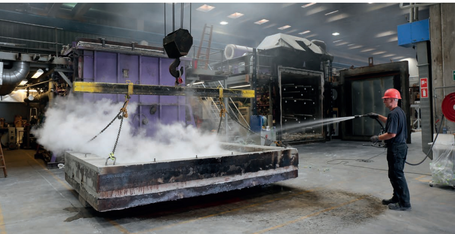
DBI har opbygget faciliteter, der gør det muligt at få en uvildig test af stort set alle komponenters modstandsevne over for brand. Foto: DBI.
