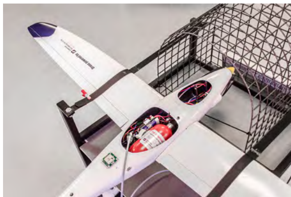
Teknologisk Institut har i FoU-projekt gennemført lovende forsøg med droner drevet af brændselsceller på brint. Herved arbejdes der på en markant forlængelse af flyvetiden for droner.
