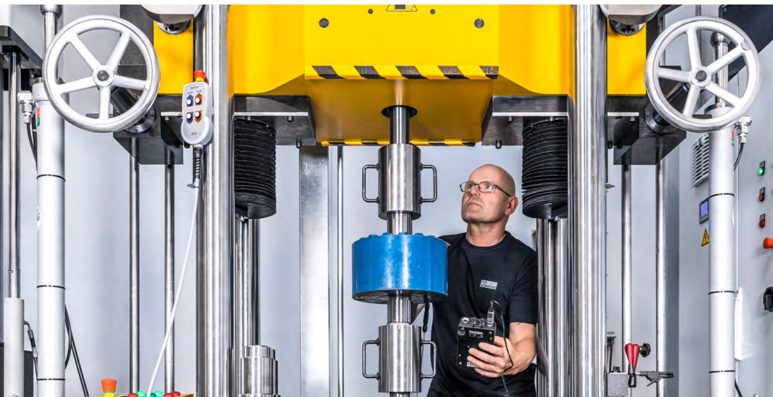
Hos FORCE Technology har virksomheder adgang til en fuldautomatisk kraftmaskine, der er fem gange mere nøjagtig end eksisterende kraftkalibreringsudstyr på det danske marked.
